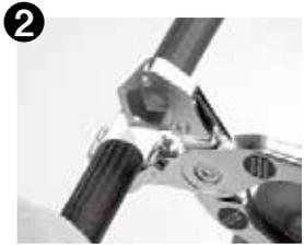
**2** 次にP365の専用カッターを使い、ケブラー・テフロンホースを切断します。
