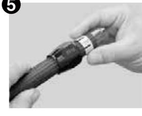
**5** 次にホース外側へ先にソケット部を入れ、次にオリーブ部の順番に通して行きます。通す順番及び向きは写真を参照して下さい。ささくれて入れにくい場合ラップテープのみを先端に巻き付け入れ込んで下さい。
