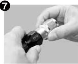
**7** 次に先程通したソケット部、オリーブ部をホースの先端まで移動させ、ナット/ニップル部を組み付けし、手で固くなるまで締め込みます。その際ネジ部にはP196のアッセンブリーループを塗布して下さい。
