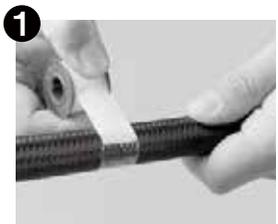
**1** 切断する箇所が切れにくく、ささくれやすい為、まず最初にP398のクリアラップテープを巻き付け、さらにその上からP398の粘着テープを巻きクリアラップテープを固定します。
