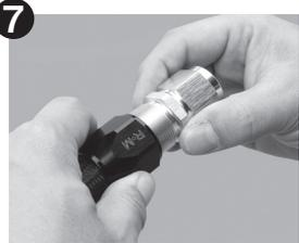
次に先程通したソケット部、オリーブ部をホースの先端まで移動させ、ナット/ニップル部を組み付け、手で固くなるまで締め込みます。その際ネジ部にはアッセンブリールーブを塗布して下さい。
