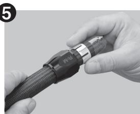
次にホース外側へ先にソケット部を入れ、次にオリーブ部の順番に通して行きます。通す順番及び向きは写真を参照して下さい。ささくれて入れにくい場合ラップテープのみを先端に巻き付け入れ込んで下さい。
