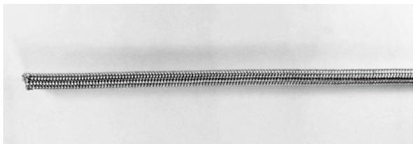
国内はもとより、世界のレースシーンで幅広く使用されている、ステンレスメッシュブレードの引き抜き成形ホースです。内壁の膨張をシャットアウトするため、ブレーキレスポンスが格段に向上します。(＃3 ホース)また、耐熱性に優れるため、レース用のターボ IN レットライン(＃4 ホース)にも使用されます。
