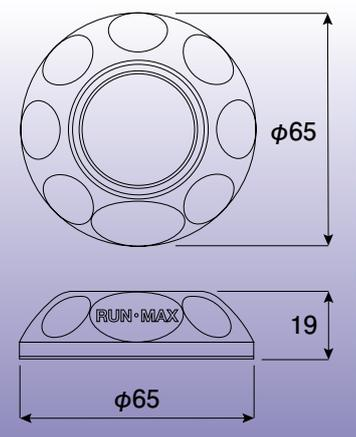
オイルフィルターが下向きに付いている車種(エンジン)にオイルクーラー(サンドイッチブロック)を取り付ける事によりブロックの厚みが出てしまい道路とのクリアランスが気になります。そこでこのLow-ハイトバイパスキャップをセットする事によりクリアランスも気になりません。(サンドイッチブロック込みで49mm程度)又、取り外したオイルフィルターは移動させるか別のインラインフィルターで対応出来ます。詳しくは P278 参照して下さい。
