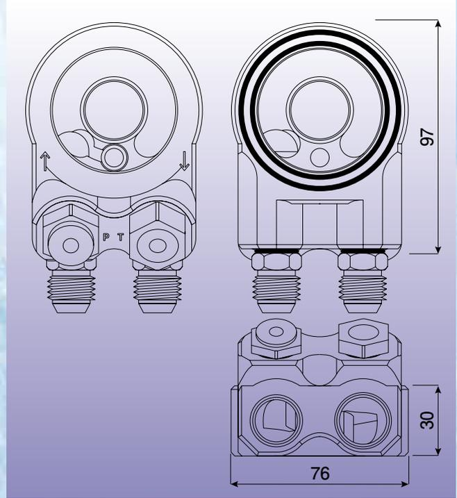
エンジンとの O-リング当り面を 2 面(ダブル)にしました。これでオイルの漏れはまず皆無です。オイルの流動性を十分に考慮した設計は、K400 (P64)とまったく同じです。それにプラス油温計・油圧計のセンサー取り出しが付いたブロックです。オイルラインと油温計・油圧計のポートは、取り出しの関係、上記写真( )でおわかりのように上下のポートを使い分ける(入替る)事が出来ます。油温計センサーアダプターに関しましてはメーカーによりネジサイズが異なりますので、下記アダプターサイズ表よりお選び下さい。
