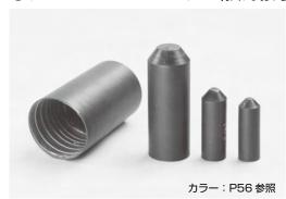
ドライヤーやヒートガンで加熱する事により今までとは違いキャップ内側 に塗布されたスパイラル状の接着剤が溶解し完璧な気密性、防水性の効果 を発揮します。配管はもちろん特に配線類などの端末部(切り口)の処理に は最適です。又、絶縁(~1000V)の効果も有ります。
