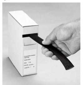
スリーブ式 (割れ目の無いタイプ) PET メッシュ素材です。 見た目の悪いバラけた配線やバキュームホースなどを 1 本に束ね "スッキリ" させます。太さに応じふくらませて端の方から差し込んで奥の方へ突いて行く要領で作業を行ないます。広げると縮もうとする反発(性質)を利用してかぶせた物の大きさに応じピッタリフィットします。
