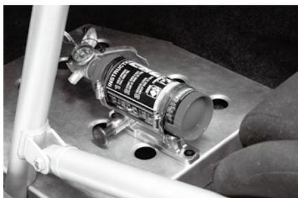
ベース部の固定は平面にボルト&ナット締めにて。
