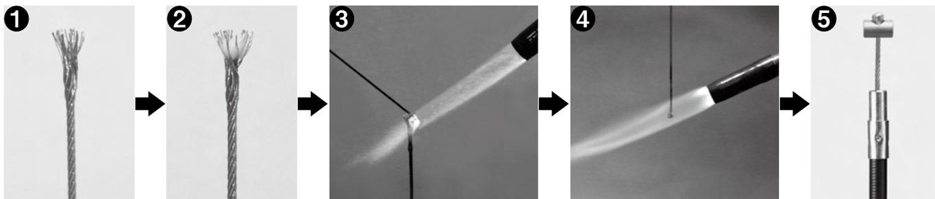
① ワイヤーの先端は、ワイヤーのよれを取り除き 10 mm 程度ささくれさせ開きます。
