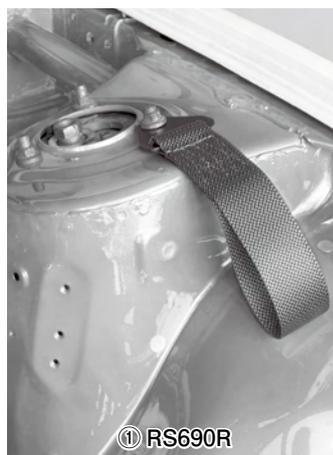
トラブルで車が動かなくなった場合のけん引用フックです。今までは金属製の突起が残る危険でしたが、この製品は布製でソフトタッチですのでボディにキズが付きづらく、歩行者などにも安全です。取り付けは、フロントバンパー廻りで基本的には先端金属プレートの穴とボディ側の穴を利用してボルトで固定します。又、写真でおわかりのようにエンジンルーム内ストラットのナットを利用して固定する事も1つの方法です。
