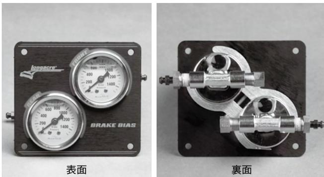
キャリパー交換などをしてプロポーションバルブ P309 を取り付けした場合、調整が目安(勘)ではなく車内で圧力を確認する事が出来ます。
