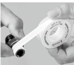
ガソリン対応品です。ちなみにホームセンターなどで販売しているテープの多くは水専用品ですので使用不可>>確認して下さい。NPT & PT (テーパネジ) 部分には、漏れ防止及びゆるみ防止の為、必ず使用して下さい。
