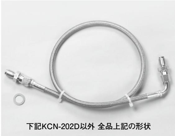
ノーマルクラッチ（スチール）パイプを使用しないでダイレクト（一本物）でマスターからオペレーティングまで通すクラッチラインです。ダンパーには通らないので、よりシビアなペダルタッチが得られます。
