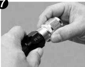
次に先程通したソケット部、オリーブ部をホースの先端まで移動させ、ナット/ニップル部を組み付けし、手で固くなるまで締め込みます。その際ネジ部にはP196のアクセサブルールを塗布して下さい。
