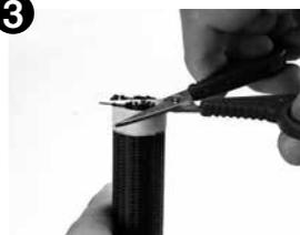
次に切れ残った場合、P365の専用ハサミを使いさくれた部分をカットして下さい。その際、表面のナイロンメッシュ部分はインナーのテフロン部分より飛び出さないようにきれいにカットして下さい。
