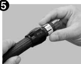
次にホース外側へ先にソケット部を入れ、次にオリーブ部の順番に通して行きます。通す順番及び向きは写真を参照して下さい。ささくれて入れにくい場合ラップテープのみを先端に巻き付け入れ込んで下さい。
