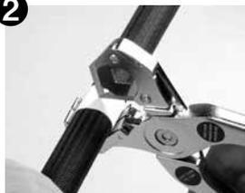
次にP365の専用カッターを使い、ナイロン+テフロンホースを切断します。
