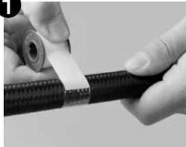
まず最初に切断する箇所がさくれ易い為、P398のクリアラップテープを巻き付け、さらにその上からP398の粘着テープを巻きクリアラップテープを固定します。
