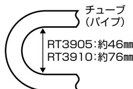
▲注意 アルミ、銅パイプ, etc. 軟質専用です。ステン、スチールパイプ, etc. 硬質使用不可
