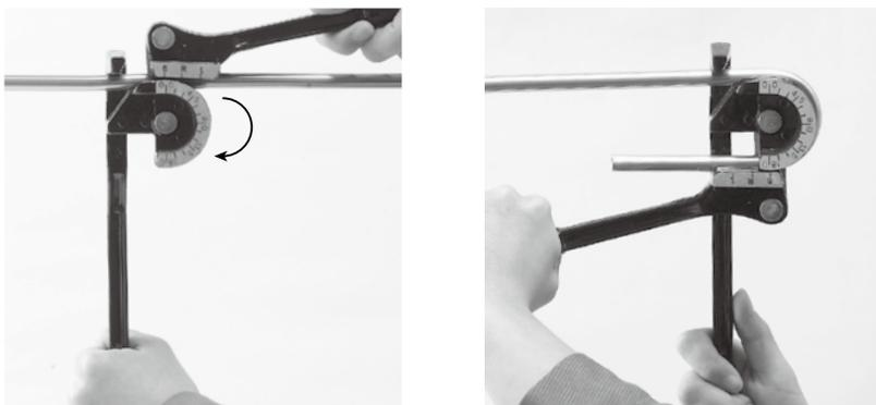
表でおわかりのように3種類(#4・#5・#6)のパイプを曲げる事が出来、角度も約180°まで、曲げ内径も約40mm(3/8"の場合)で曲げる事が出来ます。
