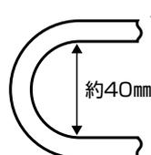
▲注意 アルミ、銅パイプ, etc. 軟質専用です。ステン、スチールパイプ, etc. 硬質使用不可
