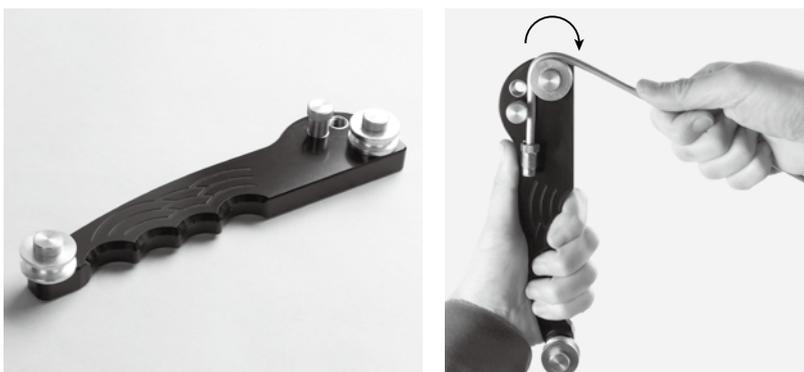
ブレーキパイプ専用ベンダーです。サイズも2種類のローラーが付属、角度も約180°まで曲げる事が出来ます。
