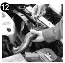
次にホースクランプのネジをマイナスドライバー又はボックスレンチで締め付けて下さい。 出来上がりです!! ロワホースも同じ手順で繰り返し
