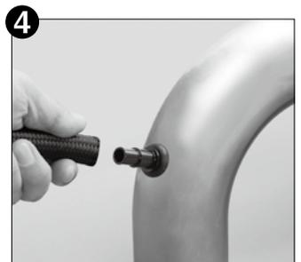
4 使用するホース内径に合わせて差し込み口外径サイズを上記表より選択して下さい。
