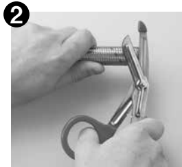
上記専用カッター使用時 切断面
