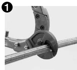
まず P343 のホースカッター（専用工具）などを使用して規定の長さにホースをカットして下さい。
