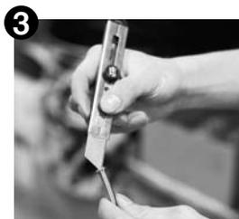
3 次にスピードフレックスホースをカットした際、内側にはバリが付いているので、カッター等を使用して取り除いて下さい。他、ナイロンコーティングホースを使用する際は、コーティング部分を 20mm 程度剥がして下さい。
