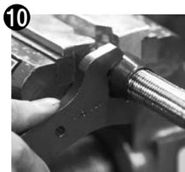
次に本締めですが、キズ・スベリ防止の為アルミホースエンドレンチ（専用工具）の使用をおすすめします。専用レンチは P340 を参考にして下さい
