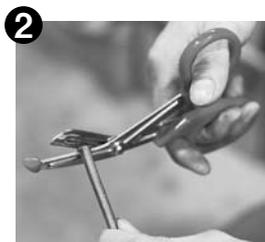
2 次にスピードフレックスホースのステンメッシュ部が内側のテフロンチューブより突き出さないようにステンメッシュ部分を P343 のハサミ(専用工具)などを使用してカットして下さい。
