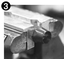
次にホースエンドのソケット部分をバイスではさんで下さい。その際、ソケット部分にキズ防止の為 P342 のバイスジョー（専用工具）をセットする事をおすすめします。
