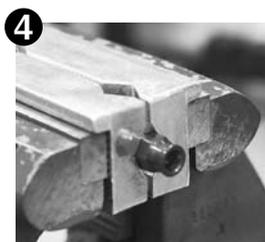
4 次にホースエンドのソケット部分をバイスではさみます。その際、ソケット部にキズ防止の為 P342 のバイスジョー(専用工具)をセットする事をおすすめします。
