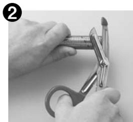
次にホースですが、ノコギリ歯（ナイロンメッシュは使用厳禁）などでカットした場合、内側のゴム部分よりメッシュ部分が突き出しているため P343 のハサミ（専用工具）などを使用して突き出した部分をカットして下さい。
