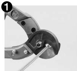
1 まず P343 のホースカッター(専用工具)などを使用して規定の長さにホースをカットして下さい。
