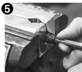
5 次に②で作業したスピードフレックスホースをバイスではさんだソケットの部分に入れる。その際メッシュ部分がささくれている場合、指先などで修正して入れ込んで下さい。
