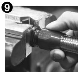
次にソケット部にホースをセットした物とナット・ニップル部分との組み付けですが先にネジ部分同士が噛合うまで手で操作して下さい。
