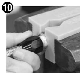
10 次にソケット部にホース/オリーブをセットした物とナット・ニップル部分の組付けですが、まず工具などを使用せず固くなるまで手で締め込んで下さい。
