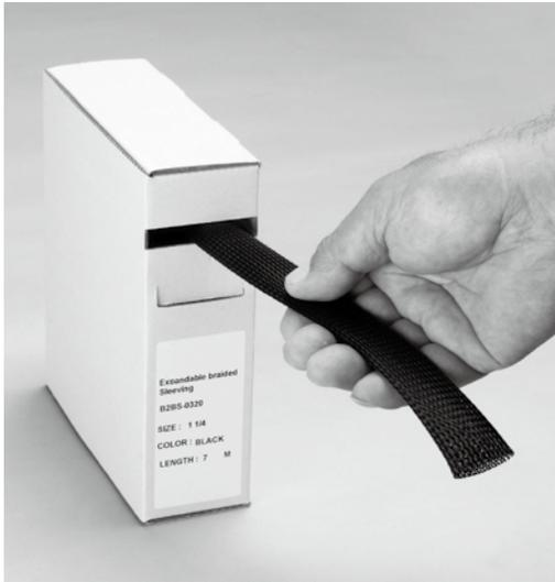
スリーブ式（割れ目の無いタイプ）PET メッシュ素材です。かっこうの悪いバラけた配線やバキュームホースなどを1本に束ね“スッキリ”させます。太さに応じふくらませて端の方から差し込んで奥の方へ突いて行く要領で作業を行ないます。広げると縮もうとする反発（性質）を利用してかぶせた物の大きさに応じピッタリフィットします。又、収納もBOX入りですのでコンパクトに納まり、使う分だけ引き出せるので非常に便利です。
