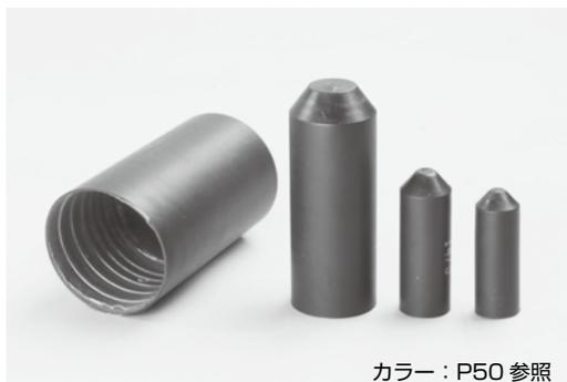
ドライヤーやヒートガンで加熱する事により今までとは違いキャップ内側に塗布されたスパイラル状の接着剤が溶解し完璧な気密性、防水性の効果を発揮します。配管はもちろん特に配線類などの端末部(切り口)の処理には最適です。又、絶縁(～1000V)の効果も有ります。
