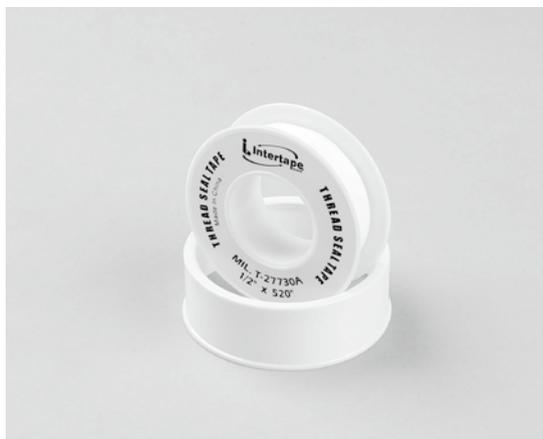
MIL規格(アメリカ軍が必要とする様々な物資の調達に使われる規格)に適合したガソリン対応品となっています。ちなみにホームセンターなどで販売しているテープの多くは水専用品ですので使用不可>>確認して下さい。NPT&PT(テーパーネジ)部分には、漏れ防止及びゆるみ防止の為必ず使用して下さい。
