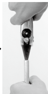
パイプ内側のバリを取る
