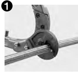
まず P333 のホースカッター（専用工具）などを使用して規定の長さにホースをカットして下さい。
