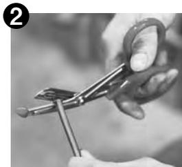
2 次にスピードフレックスホースのステンメッシュ部が内側のテフロンチューブより突き出さないようにステンメッシュ部分を P333 のハサミ(専用工具)などを使用してカットして下さい。
