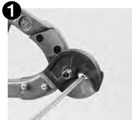
1 まず P333 のホースカッター(専用工具)などを使用して規定の長さにホースをカットして下さい。
