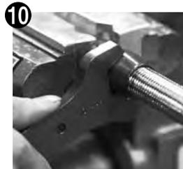
次に本締めですが、キズ・スベリ防止の為アルミホースエンドレンチ（専用工具）の使用をおすすめします。専用レンチは P330 を参考にして下さい
