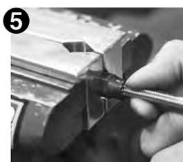
5 次に②で作業したスピードフレックスホースをバイスではさんだソケットの部分に入れる。その際メッシュ部分がささくれている場合、指先などで修正して入れ込んで下さい。
