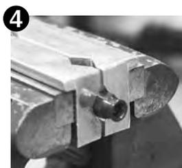
4 次にホースエンドのソケット部分をバイスではさみます。その際、ソケット部にキズ防止の為 P332 のバイスジョー(専用工具)をセットする事をおすすめします。
