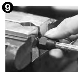
9 次にソケット部にホース/オリーブをセットした物とナット・ニップル部分の組み付けですが先にネジ部分同士が噛合うまで手で操作して下さい。
