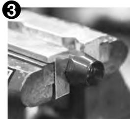
次にホースエンドのソケット部分をバイスではさんで下さい。その際、ソケット部分にキズ防止の為 P332 のバイスジョー（専用工具）をセットする事をおすすめします。
