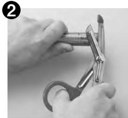
次にホースですが、ノコギリ歯（ナイロンメッシュは使用厳禁）などでカットした場合、内側のゴム部分よりメッシュ部分が突き出しているので P333 のハサミ（専用工具）などを使用して突き出した部分をカットして下さい。
