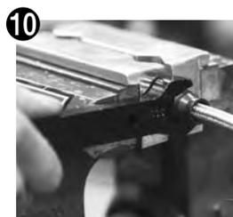
10 次に本締めですが、キズ・スベリ防止の為アルミホースエンドレンチ(専用工具)の使用をおすすめします。専用レンチは P330 を参考にして下さい。
