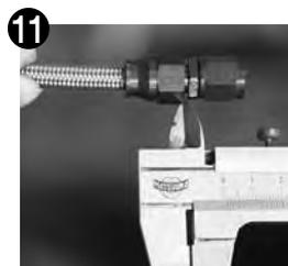
11 最後にニップル・ソケット部分のクリアランスをチェックして下さい。1mm前後が最適です。
