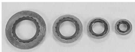
スタット O-シールは、市販品の中で最高レベルのものです。ゴム製の O-リングが、工場製作工程でアルミニウム製ワッシャーの中に固定されています。締めた場合に O-リングのゴムが圧縮されて、ボルト、ナットの溝に完全にシールします。(P166 図 2 参考)
