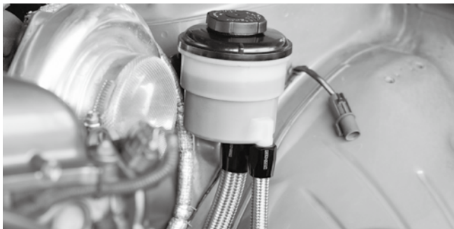
オイルタンク廻り
