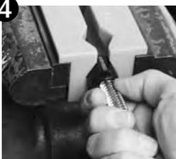
又は、上記の力の要る作業が難しくてしづらい場合、P332 の AN アッセンブリーツール(専用工具)を用いるとホースのメッシュ部分が多少ささくれていてもソケット部分に“ラクラク”セット出来ます。その際オイルの配布を忘れずに。
