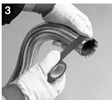
3 絞り込んだステンレスブレードをホース先端に合わせて片側をずれないようにビニールテープで固定します。
