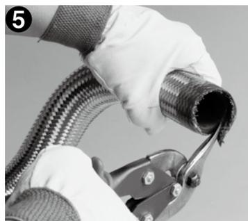
5 ホース先端より飛び出した両側のステンレスブレードを金切りハサミなどでカットし、終了です。
