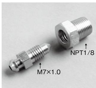
NPT1/8メスのサービスホールなどに土台をセットしてスクリューを緩めれば簡単に水ライン及びオイルラインなどのエア抜きが出来る便利なブリーダーです。
