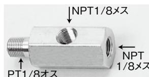
ノーマルのプレッシャースイッチ(油圧計)の機能を残しつつ新たに追加油圧計又は油温計(電気式)ラインが取り出し出来るアダプターです。又、後付けターボのオイル取り出しラインにも利用できます。
